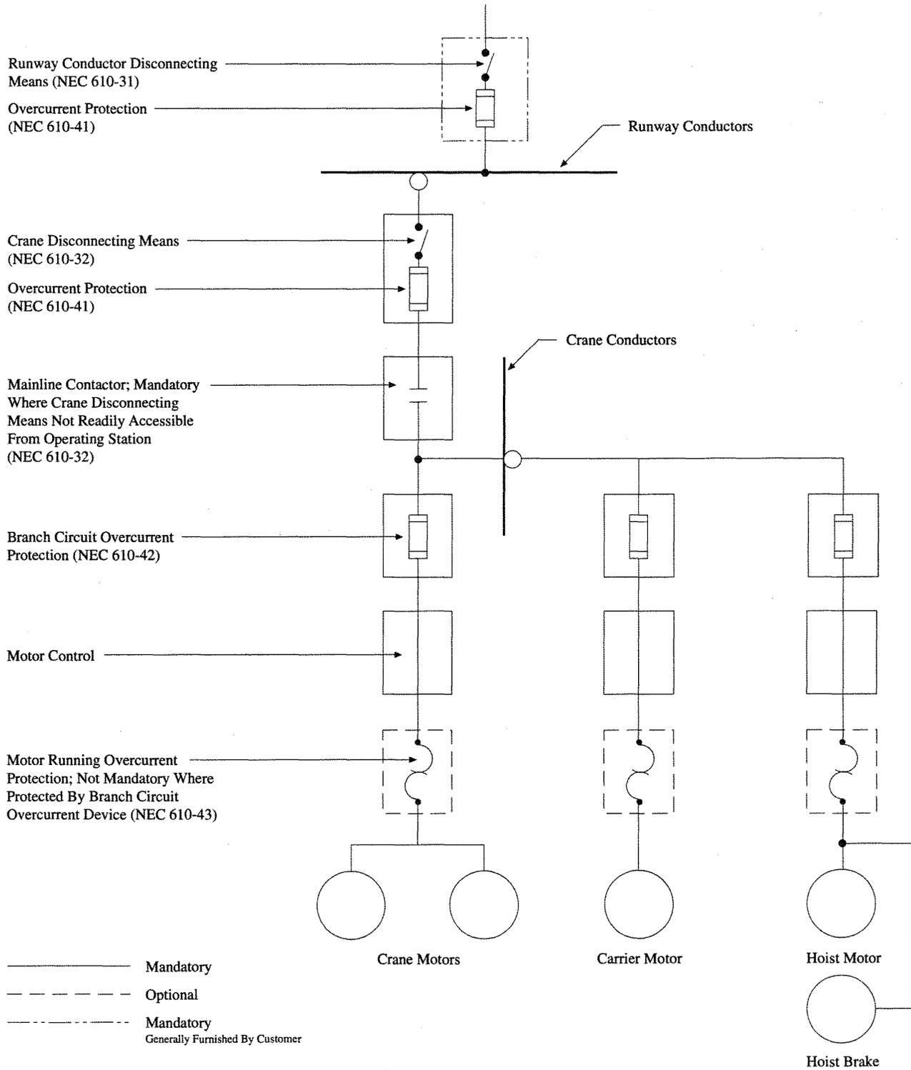
**ELECTRICAL DIAGRAM - MOTOR DRIVEN MONORAIL CARRIER**
